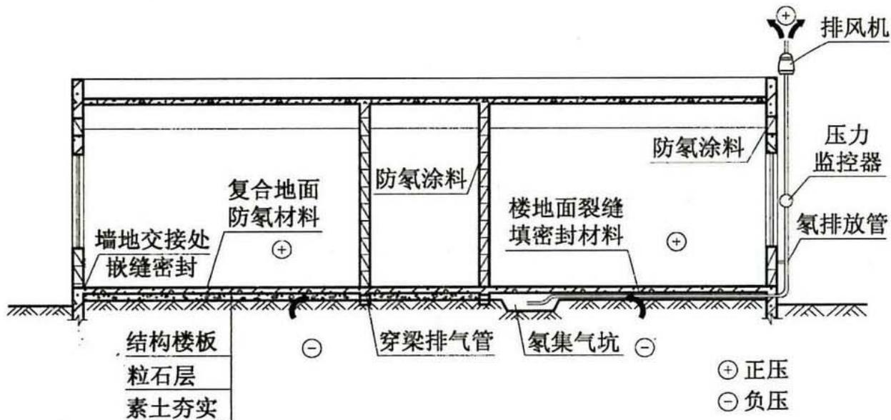
图 D. 0. 5 土壤降压法系统图
